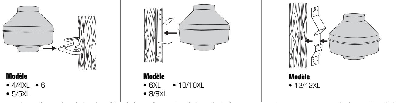
Le support du ventilateur devrait être installé, puis le ventilateur devrait être placé directement sur le support au moyen de vis pour le métal.
