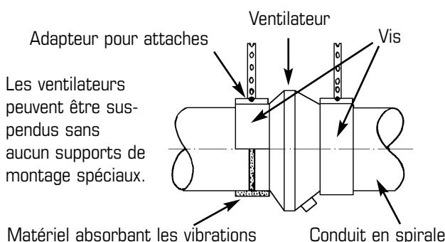
**Placement des vis de montage et du crochet**
