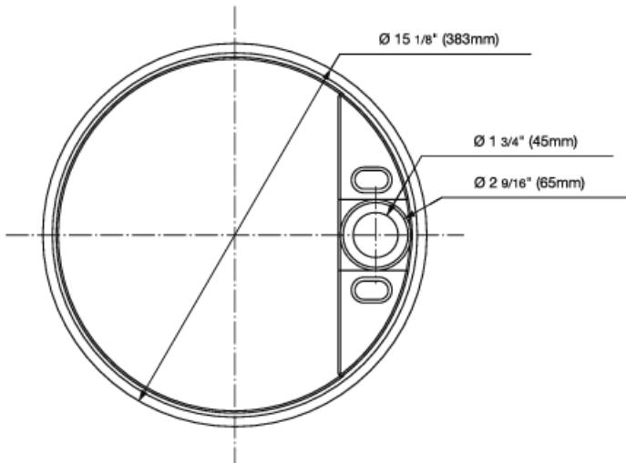
DRAIN COVER SIDE VIEW / VISTA LATERAL DE LA TAPA DE DRENAGE / VUE LATÉRALE DU COUVERCLE DE DRAIN
