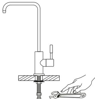
Serrez doucement le raccord avec une clé.
