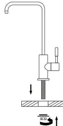
Insérez le robinet dans le trou du comptoir et serrez l'écrou de montage.
