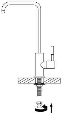
Branchez le connecteur de taille appropriée. Nous incluons un connecteur de 1/4 po et un connecteur de 3/8 po. Tuyau d'alimentation raccordé (non fourni avec ce robinet)
