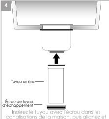
Insérez le tuyau avec l'écrou dans les canalisations de la maison, puis alignez et fixez l'écrou du tuyau de sortie sur le corps de la crépine.
