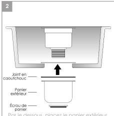
Par le dessous, placez le panier extérieur avec un joint en caoutchouc sous l'évier et fixez-le avec l'écrou du panier.
