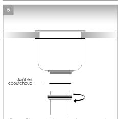
Serrez l'écrou du tuyau sur le corps de la crépine, assurez-vous que le joint en caoutchouc est bien en place.
