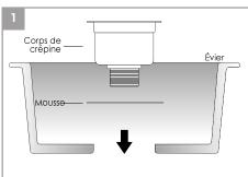
Placez le joint en mousse et la crépine sur le côté supérieur de l'ouverture du drain. On pourrait aussi utiliser du mastic de plombier au lieu d'un joint en mousse.
